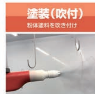
粉体塗装は溶剤塗料に比べ塗膜を厚くでき均一な塗装ができます
