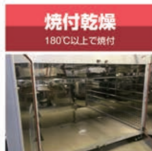
2160ℓの大容量の乾燥炉を使い180℃以上の高温で焼きつけます
