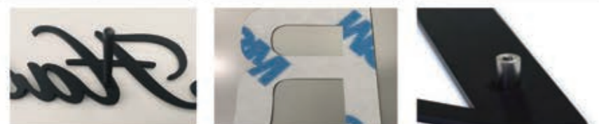
プラスト処理などの下処理をします 粉体塗料を吹き付け 乾燥炉を使い180℃以上で焼きつけ
